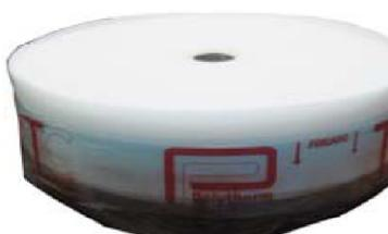
Banda de espuma de polietileno. Se instala como rodapie en todos los paramentos verticales para absorber las dilataciones del mortero y de los pavimentos y para evitar puentes térmicos con los cerramientos. Incorpora un film de polietileno para evitar la filtración de mortero entre el aislamiento perimetral y aislamiento del suelo
