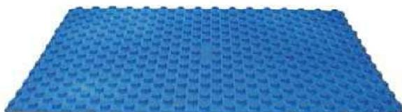
Planchas de poliestireno expandido plastificado ( EPS ) de altura reducida, fabricado mediante termoconformado según norma UNE 1264. Con elevado poder aislante, termoacustico y célula cerrada. Tochos integrados en la placa con rebajes laterales para la fijación del tubo. Bordes solapados para eliminar la formación de puentes termoacústicos con el forjado. Admite tubos de 12 mm.
