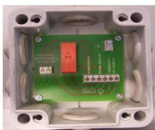
Caja eléctrica con rele montado en circuito impreso , recibe señal libre de tensión de un termostato , micro de una válvula de zona, placa electrónica , etc y tiene 2 salidas una con tensión para alimentar una bomba y otra libre de tensión para arancar la caldera.
