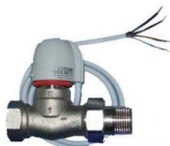
Válvulas de zona con accionamientos termoeléctricos para montar en la entrada del distribuidor. Estado NC (cerrado sin tensión). Consumo 2 W . Tiempo de apertura 5 minutos.
