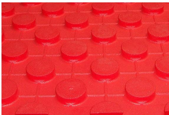
Planchas de poliestireno expandido plastificado ( EPS ) fabricado mediante termoconformado según norma UNE 1264. Con elevado poder aislante, termoacustico y célula cerrada. Tochos integrados en la placa con rebajes laterales para la fijación del tubo. Bordes solapados para eliminar la formación de puentes termoacústicos con el forjado. Admite tubos de 15 y 16 mm.
