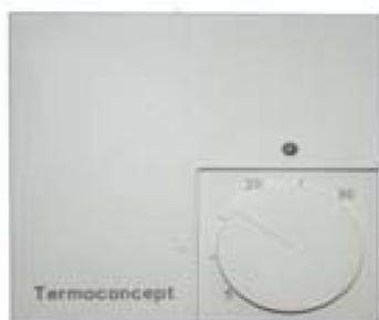
Termostato ambiente electrónico regulación por ruleta, necesita un mínimo de 3 hilos (línea , neutro y retorno de línea) preparado para descenso térmico nocturno de 2 °C conectándole un cuarto hilo.
